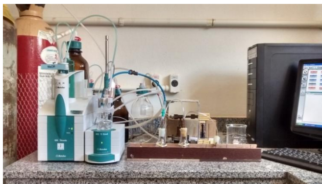
Figura 6 Titulador potenciométrico e sistema de degaseificação
