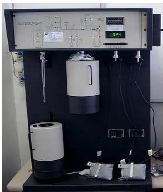
Figura 11 Aparelho para medição de área superficial (modelo autosorb1) Fonte: Autor
