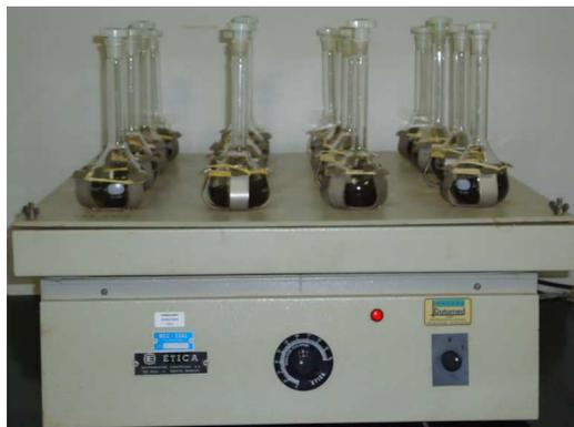
Figura 2 Mesa com movimento horizontal. (Laboratório de Relação Água-Solo-Planta do setor de Engenharia de água e solo, UFLA, 2013)
