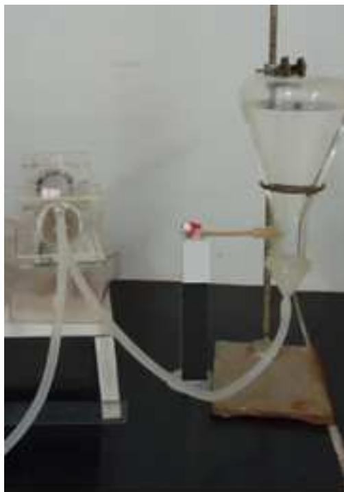
Figura 1 Equipamento usado no ensaio de infiltração horizontal
