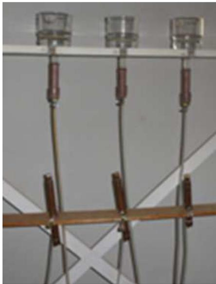
Figura 1 Funis de placa porosa usados na determinação da curva de retenção. Fonte: Foto realizada na Universidade Federal de Lavras - UFLA (2013).
