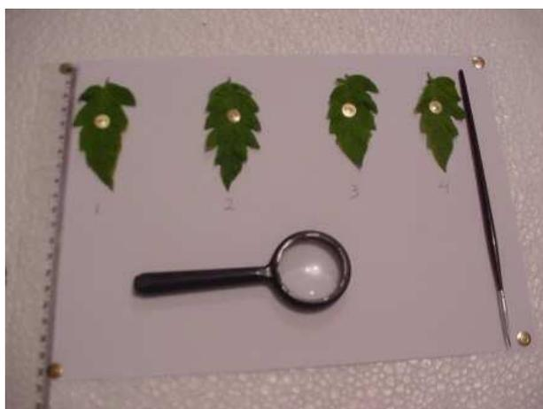
Figura 13 Aspecto geral do procedimento para determinar a atividade acaricida
