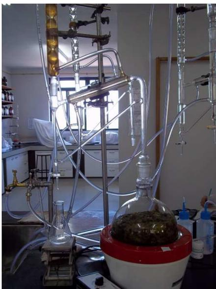
Figura 11 Aspecto geral do processo de extração de óleo essencial com o aparelho de Clevenger modificado
