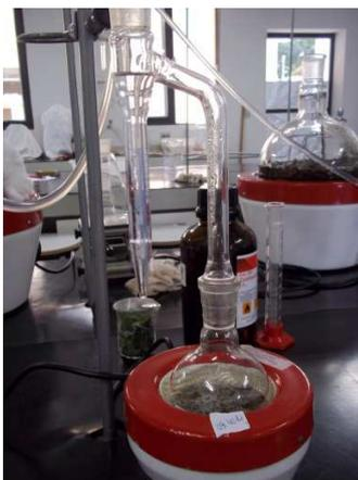
Figura 12 Aspecto geral do processo para determinação de umidade com o aparelho Dean stark
