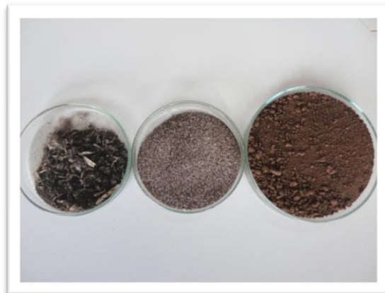
Figura 8 - Amostra fracionada de resíduos do gradeamento da ETE. Da direita para a esquerda: resíduo orgânico, areia e silte
