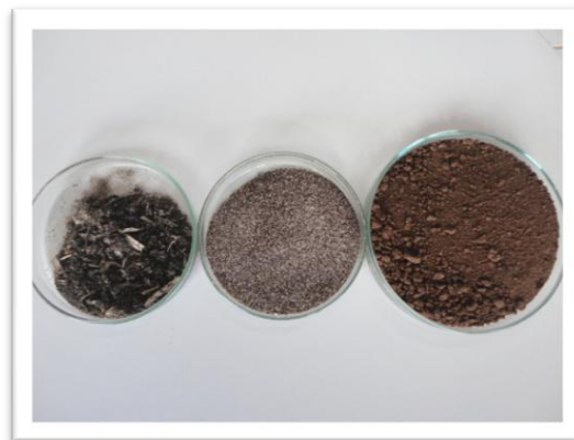
Figura 7 - Amostra fracionada de resíduos do gradeamento da ETE. Da direita para a esquerda: resíduo orgânico, areia e silte
