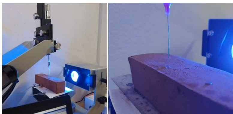
Figura 5 - Imagem do ensaio de ângulo de contato.
