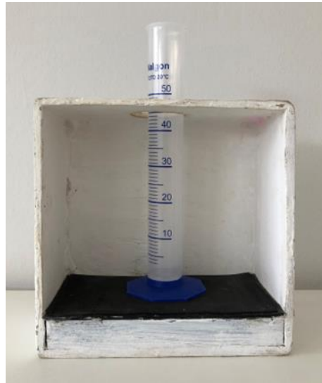
Figura 4.2 – Aparato utilizado para compactação do material.
