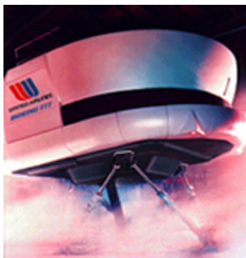
Figura 3.1: O simulador de voo da Boeing 777 considerado a mais sofisticada aplicação de RV, fonte [Hos01].
