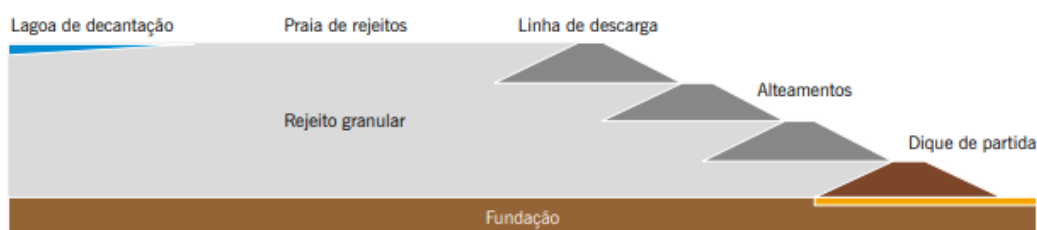
Figura 2.2 – Método de alteamento a montante.
