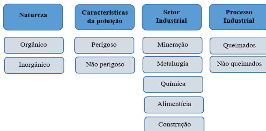
Figura 2 - Diagrama esquemático da classificação dos resíduos sólidos industriais.
