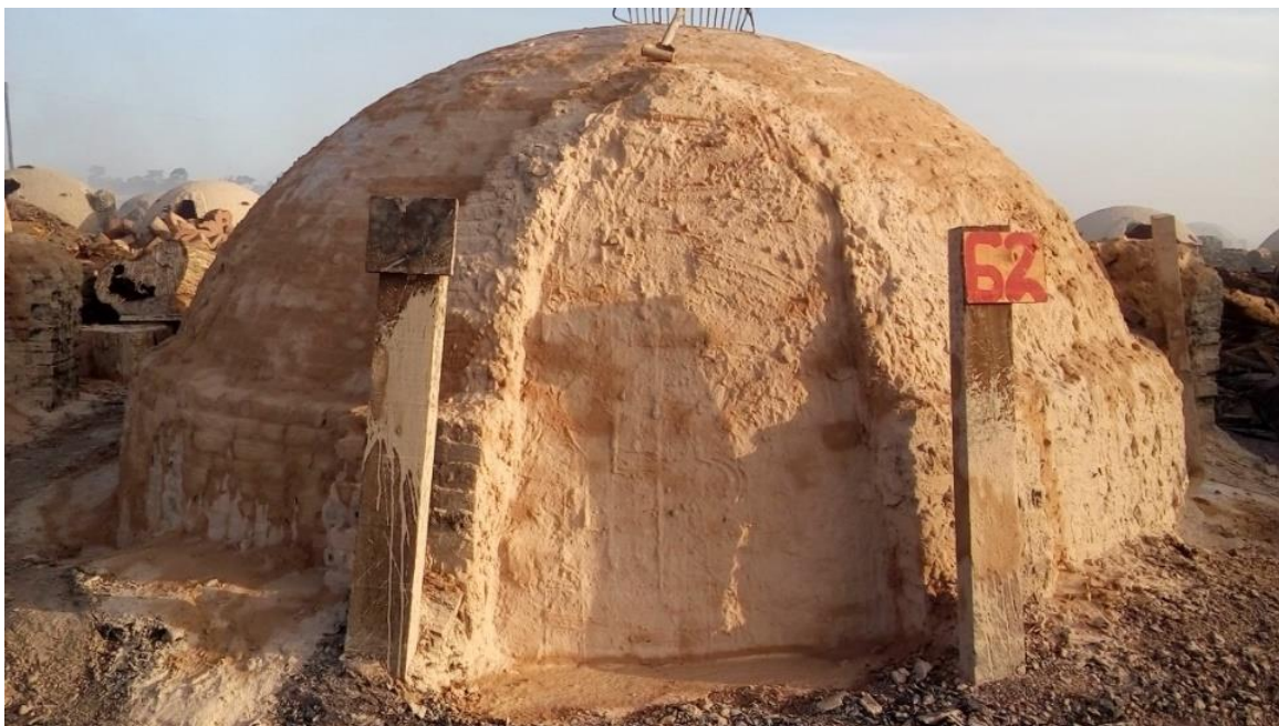
Fig. 1 Forno de alvenaria utilizado na carbonização dos resíduos madeireiros do manejo florestal sustentável.
