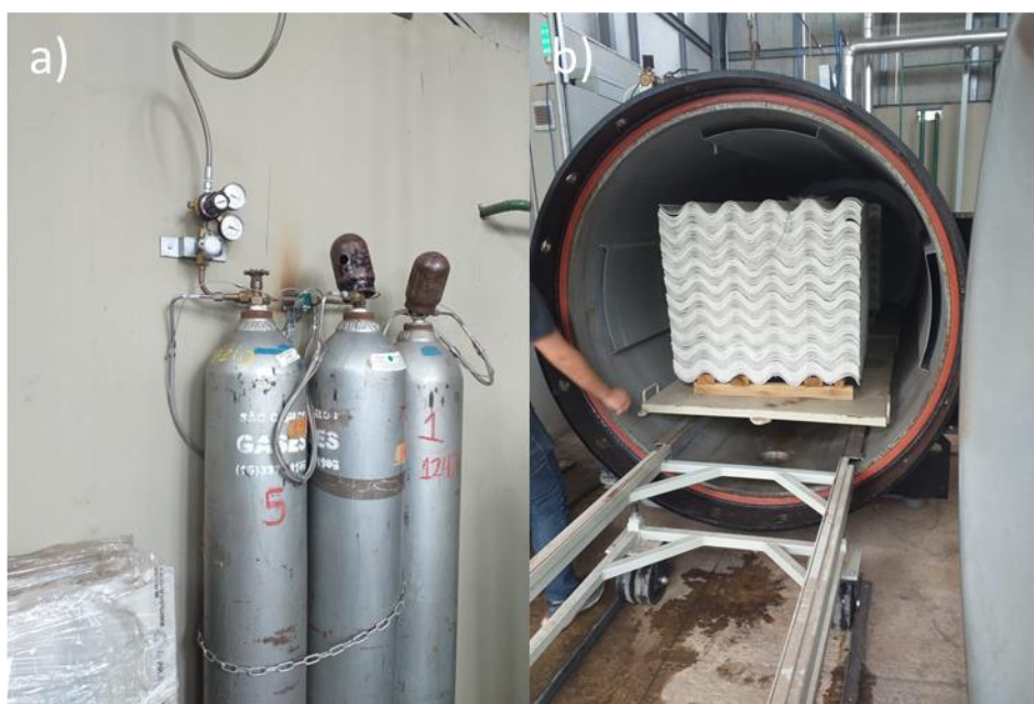
Figura 12 – Processo de carbonatação acelerada em ambiente com saturação de CO 2 .
