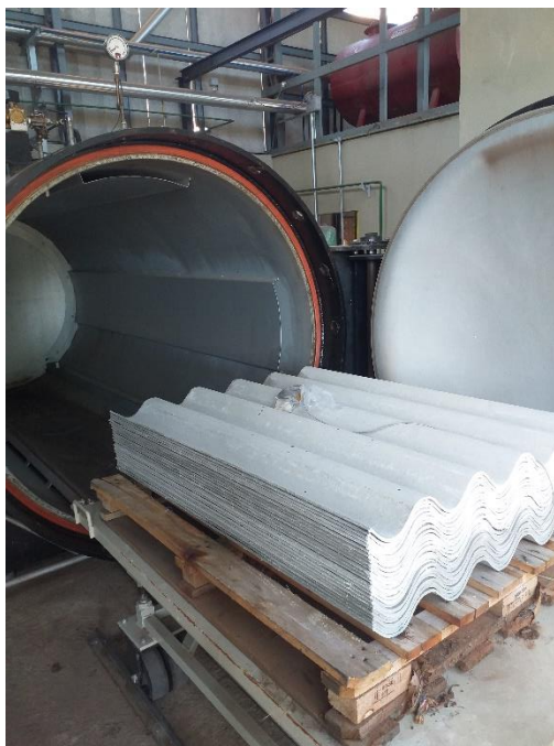
Figura 14 – Pilhas de 25 telhas inseridas no processo de carbonatação com volume de ocupação estimado de 17%.
