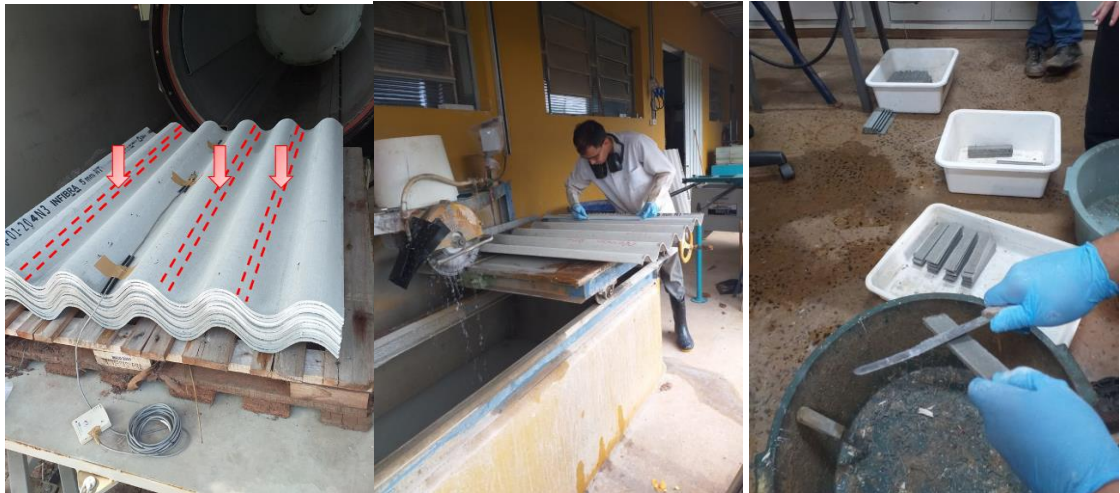
Figura 17 – Etapa de cortes dos corpos de provas nas telhas onduladas.
