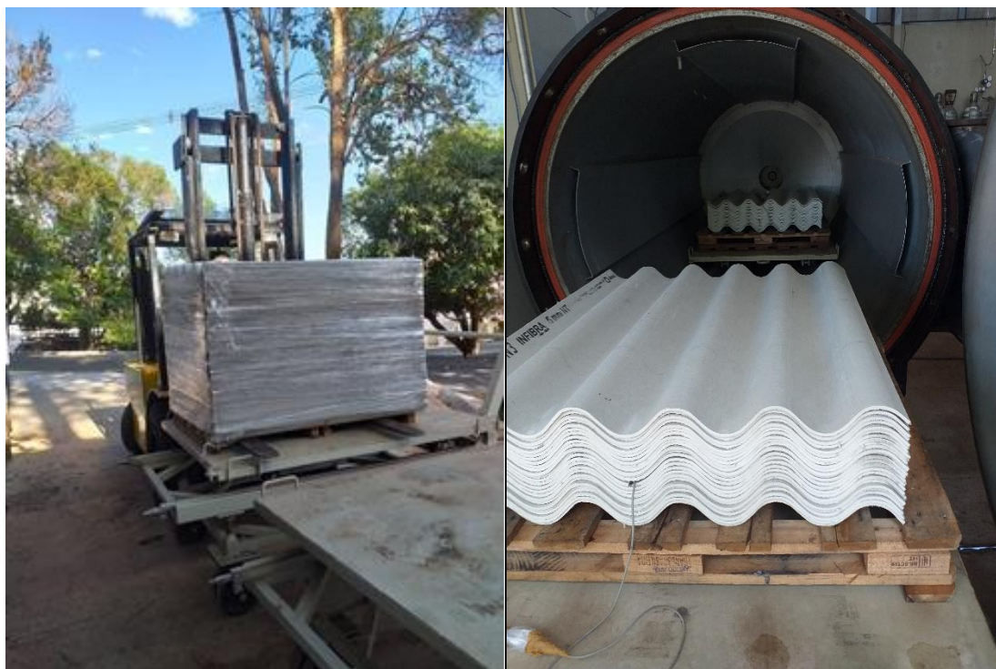
Figura 11 – Telhas preparadas para o processo de carbonatação em Autoclave com volume de ocupação estimado de 17%.
