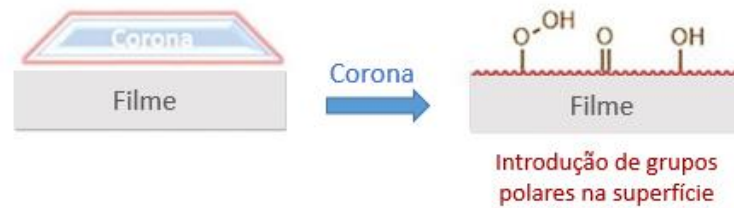
Figura 8 – Introdução de grupos polares na superfície de filmes após aplicação de corona
