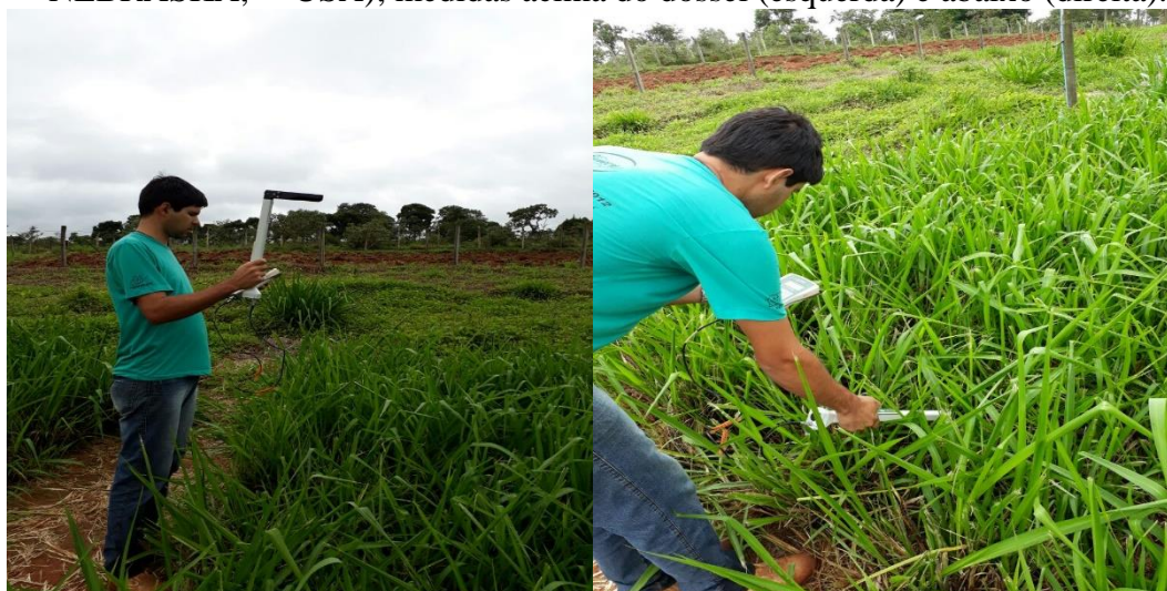
Figura 4 – Analisador de interceptação luminosa LAI 2200 (LI-COR, LINCOLN NEBRASKA, USA); medidas acima do dossel (esquerda) e abaixo (direita).
