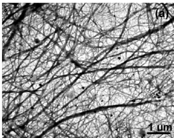
Figura 3 - Micrografias de transmissão de nanofibrilas de celulose preparadas a partir de fibras de Opuntia ficus-indica
