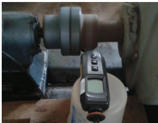
Figura 11 Determinação da rotação da bomba com Tacômetro TDR-100
