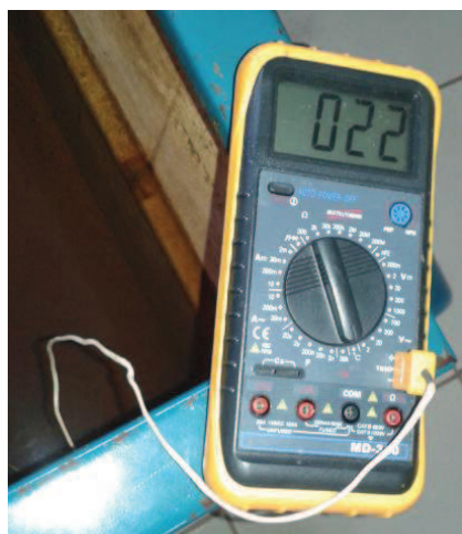
Figura 10 Determinação da temperatura da água com o multímetro MD-380
