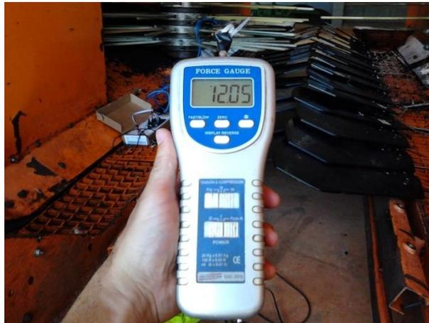
Figura 8 Dinamômetro portátil utilizado para quantificar as forças no cilindro vibrador
