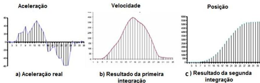
Figura 19 Representação gráfica da transformação aceleração em posição
