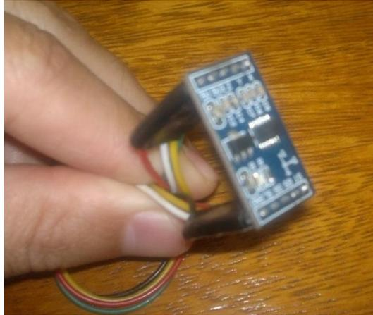
Figura 9 Acelerômetro triaxial MMA7361
