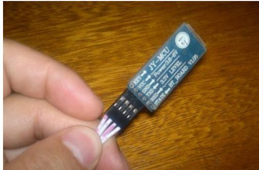
Figura 11 Módulo de comunicação bluetooth modelo Rs232
