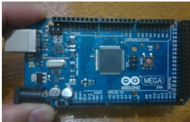
Figura 10 Microcontrolador Arduino Mega 2560
