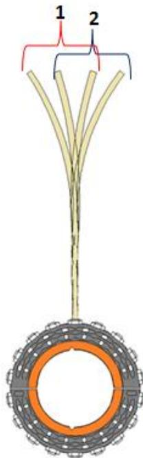
Figura 34 Comportamento de vibração horizontal da haste caracterizado pela não exatidão de frenagem do cilindro
