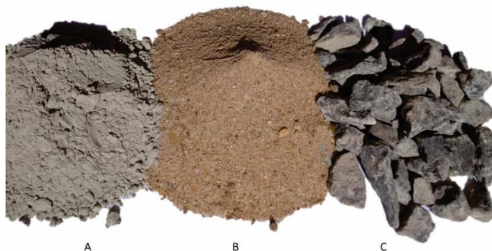
Figura 1- Materiais básicos constituintes do concreto.
