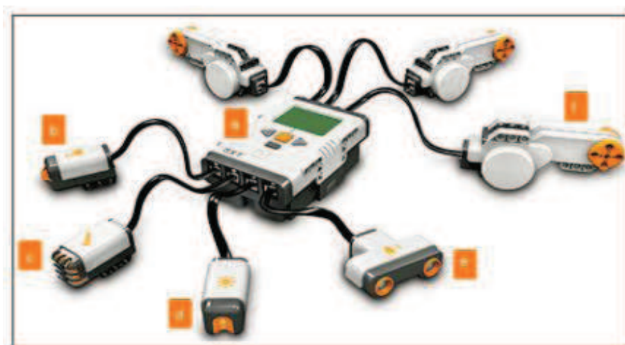
Figura 1 Kit Lego Mindstorms NXT (a) CPU. (b) sensor de toque. (c) sensor de som (d) sensor óptico (e) sensor ultrassônico (f) motores de passo
