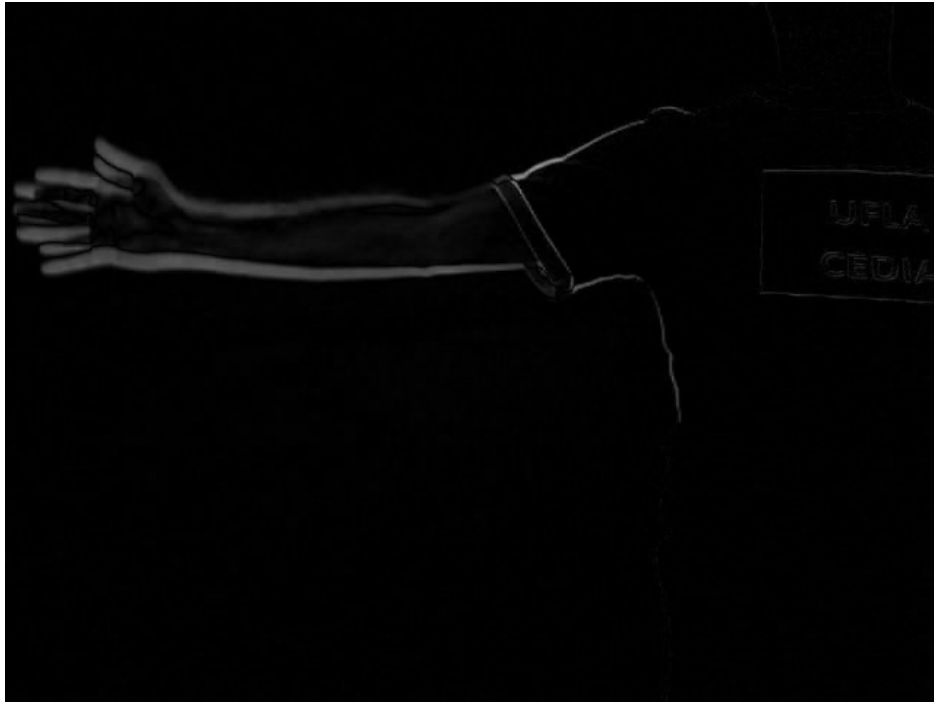
Figura 4 Silhueta gerada pela subtração de duas imagens em sequência
