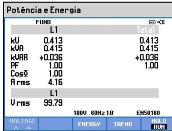
Figura 4.12 – teste experimental com o CFR com carga R: Potência ativa, reativa e aparente.
