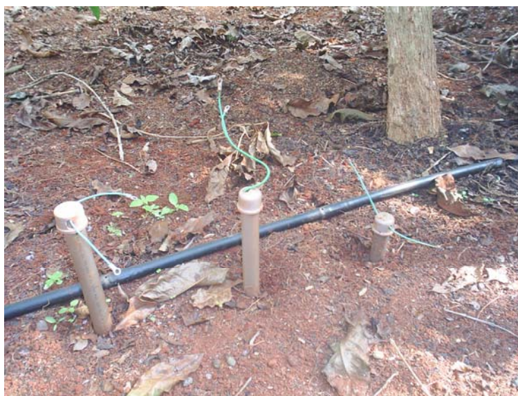
Figura 8 Disposição dos sensores de umidade do solo na linha de plantio. UFLA, Lavras-MG, 2010
