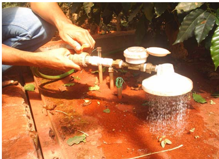
Figura 11 Vista do equipamento utilizado nas irrigações nos lisímetros. UFLA, Lavras MG, 2010
