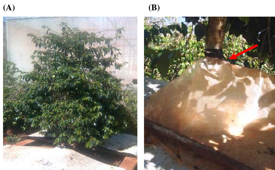
Figura 12 Cobertura construída para evitar entrada de água de chuva no isímetro externo (A) e, detalhe da fixação do plástico no tronco da planta (B). UFLA, Lavras-MG, 2010
