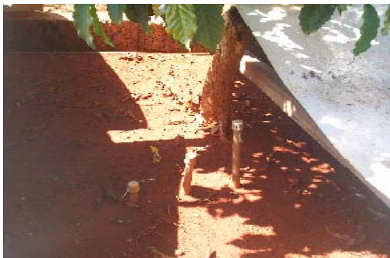
Figura 10 Sensores de tensão de água no solo, instalados junto à planta, nas profundidades de: 10, 30, e 50cm, para o controle da irrigação e monitoramento do fluxo de água. UFLA, Lavras-MG, 2010
