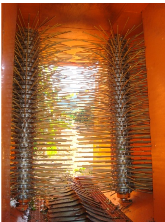
Figura 2 Sistema de varetas da colhedora K3 Millennium
