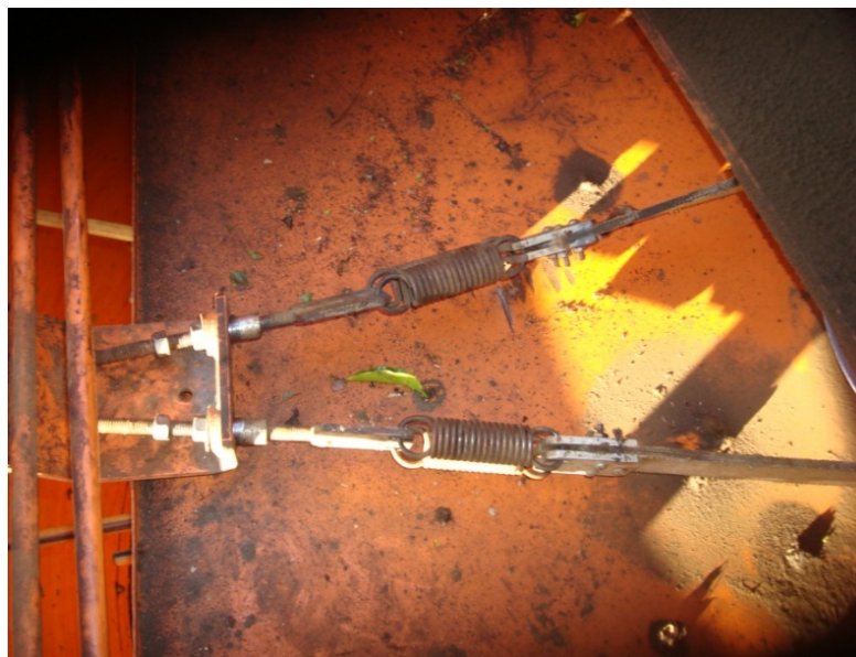
Figura 3 Regulagem da força na cinta de freio
