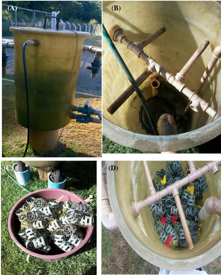
Figura 5. Visualização externa (A) e interna (B) do filtro biológico aerado submerso utilizado experimentalmente no tratamento do esgoto sanitário da UFLA; anéis de Pall utilizados no preenchimento do FBAS (C), e distribuição dos sacos tipo rede com os anéis de Pall dentro do FBAS (D).
