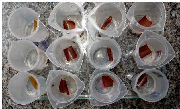
Figura 1: Filmes de quitosana e ácido láctico em processo de solubilização.
