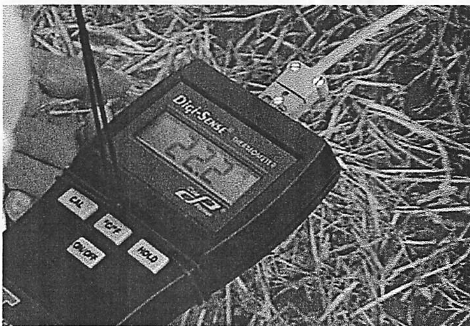
FIGURA 3 Termômetro digital para sensor termopar tipo T (cobre-constantan).
