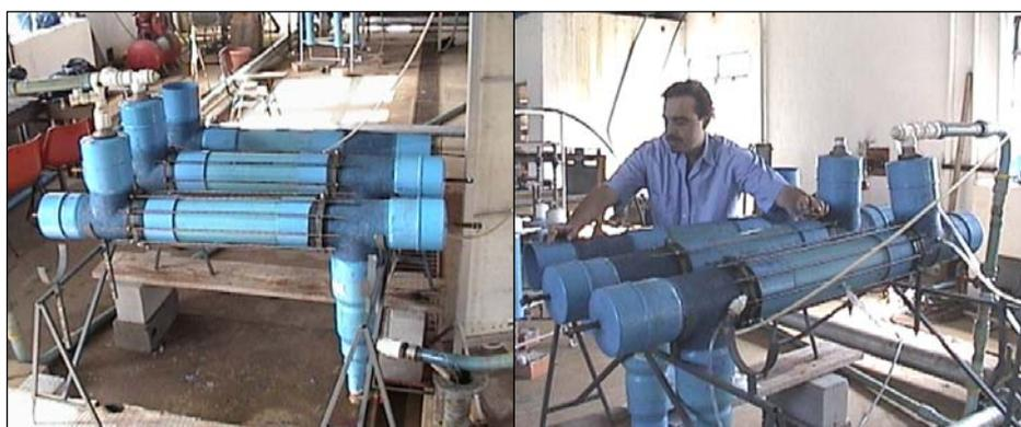
FIGURA 13. Protótipos dos filtros.
