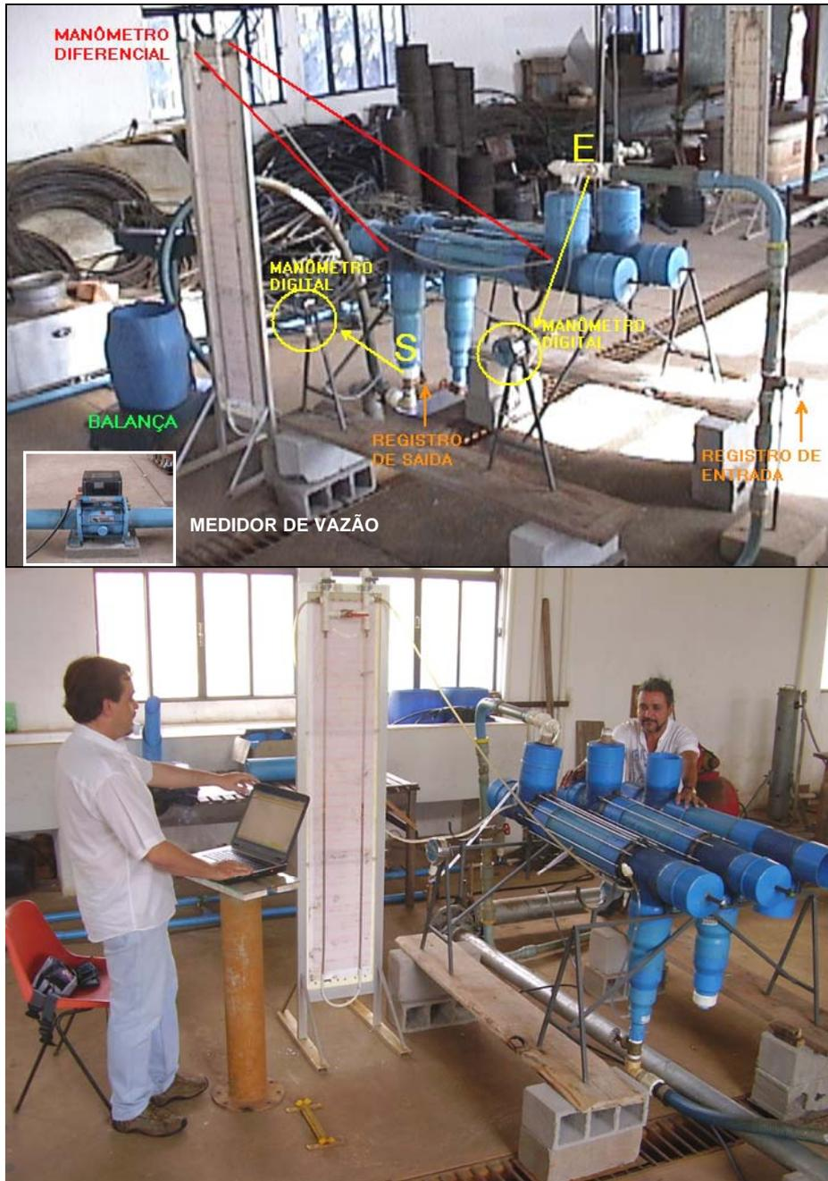
FIGURA 19. Ensaio de perda de carga dos protótipos.
