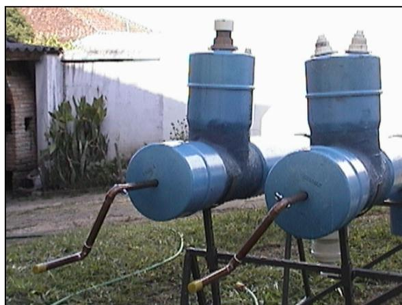
FIGURA 17. Manivelas do sistema de limpeza dos protótipos.
