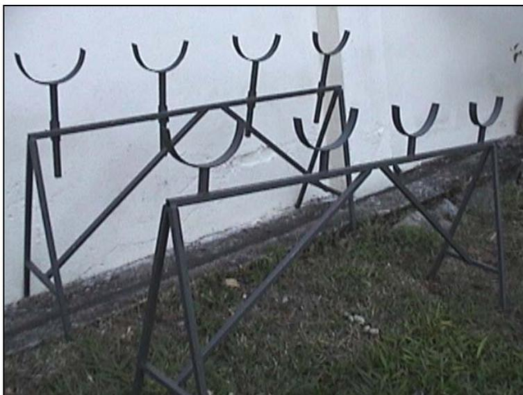
FIGURA 18. Bancada de sustentação dos protótipos.
