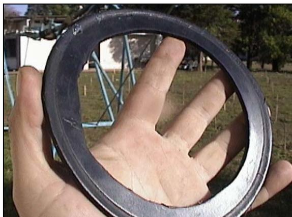
FIGURA 14. Anel de vedação dos protótipos.
