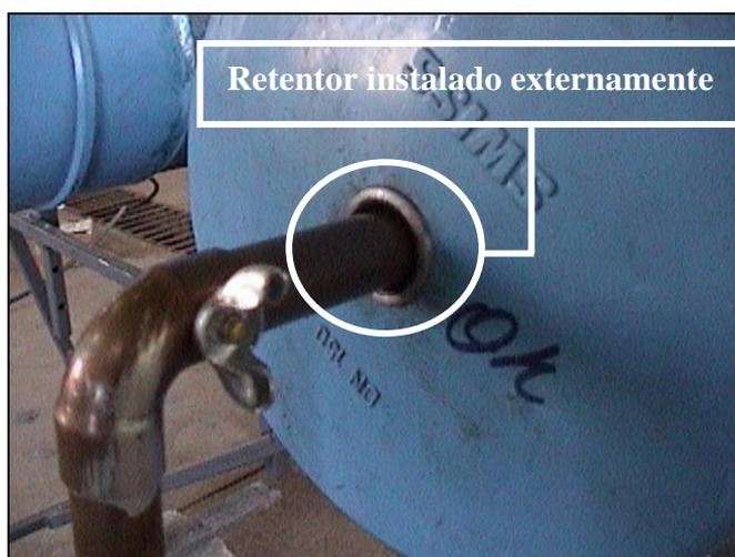
FIGURA 15. Retentor do protótipo.
