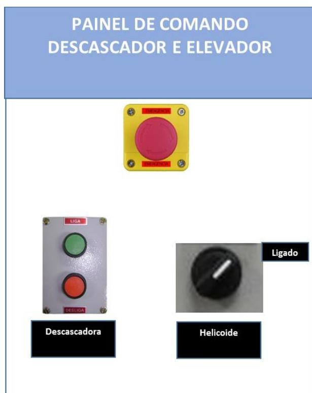
**Figura 2** - Esquema painel de comando: segundo helicóide.
