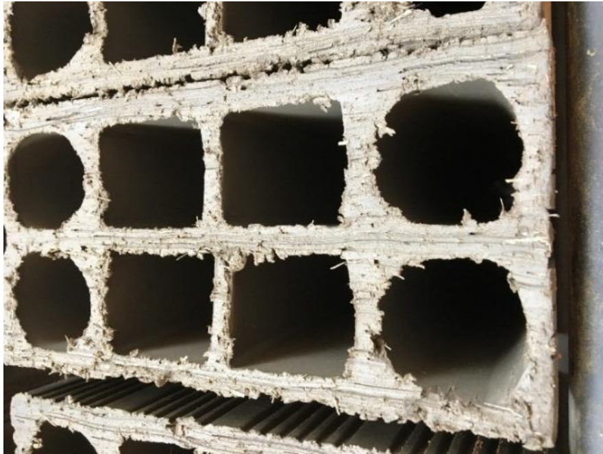
Figure 7 – Bloco cru produzido com 10% de substituição de solo por fibra de resíduos.
