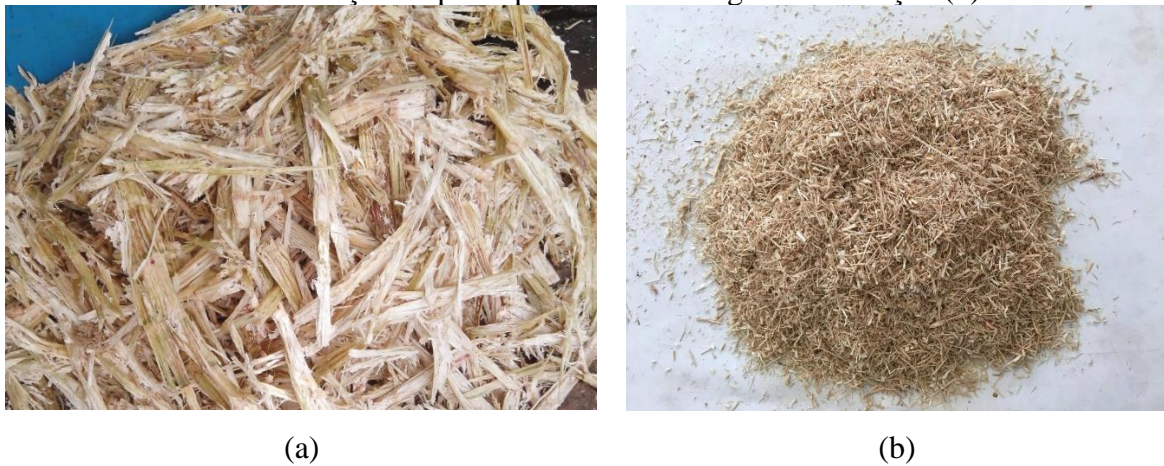
Figure 4 – Bagaço de cana-de-açúcar fornecido coletado no pátio da empresa (a), fibra do bagaço de cana-de-açúcar após o processo de secagem e trituração (b).
