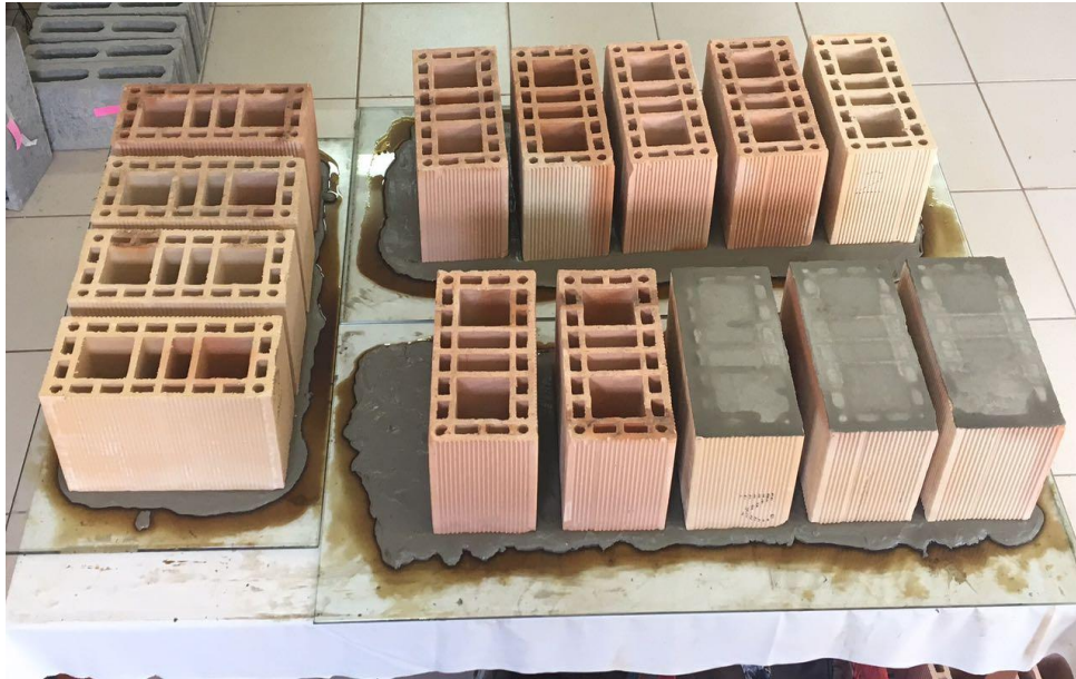
Figura 5 – Processo de capeamento dos BCQs.
