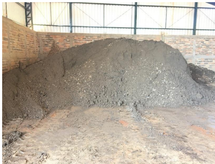
Figura 3 – Massa de solo logo após o processo de pré-mistura
