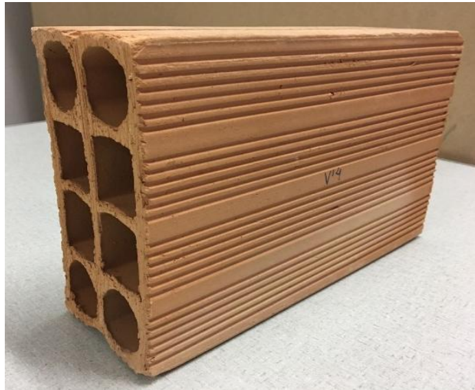
Figure 8 – Corpo-de-prova para avaliação da condutividade térmica do bloco.
