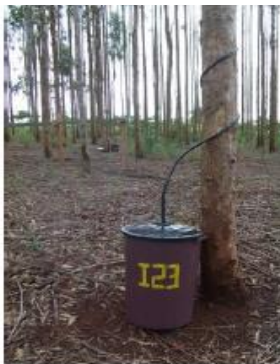
Figura 9 - Sistema de coleta do escoamento do tronco, mangueira fixada em espiral no tronco e balde coletor.
