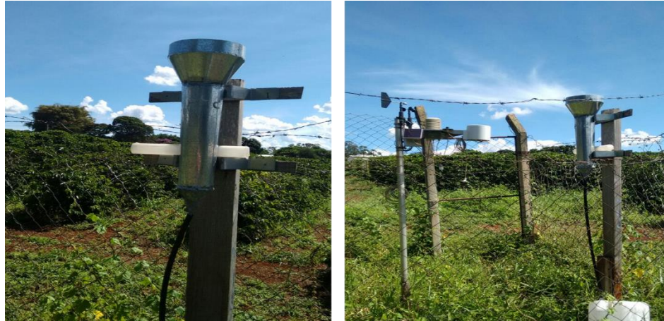
Figura 7 - Pluviômetro “Ville de Paris” instalado em local aberto a 150 m do povoamento.
