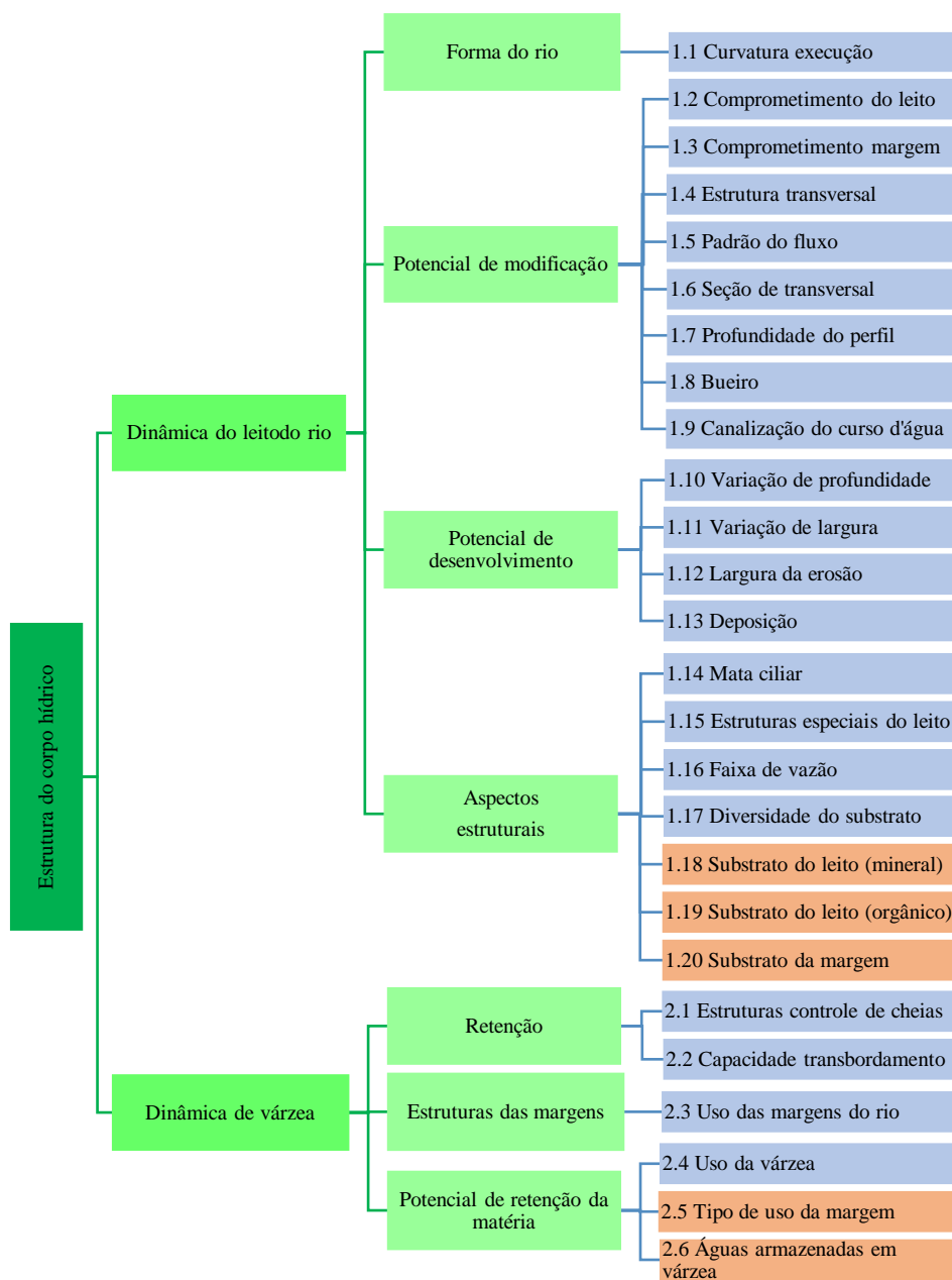
Figura 2 – Estrutura da avaliação de corpos hídricos pelo Método Bávaro.
