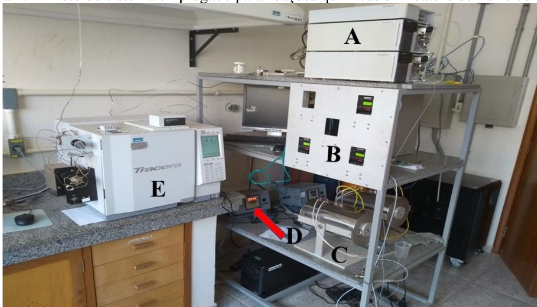
Figura 4.1 – Foto do sistema empregado para reações químicas em reator de fluxo contínuo.
