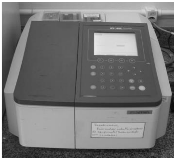
Figura 10 Aparelho utilizado para obtenção das concentrações nos testes de cinética e isoterma de adsorção
