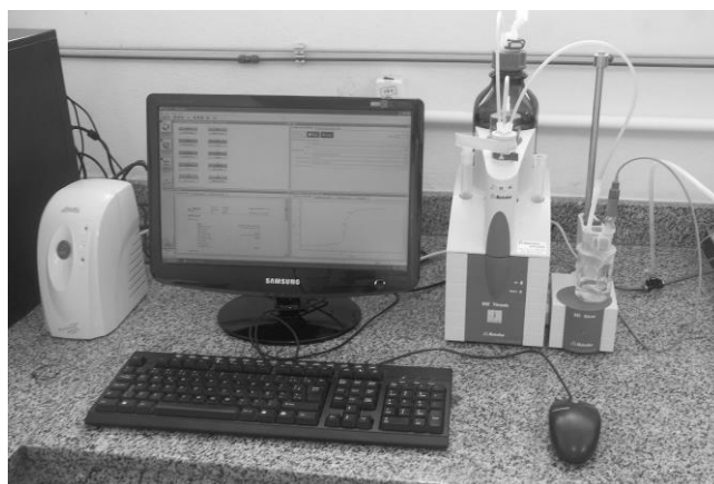
Figura 9 Aparelho titulador utilizado para obtenção dos grupos funcionais
