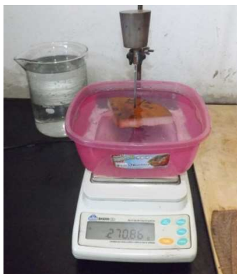
Figura 13 Metodologia de obtenção do volume saturado das cunhas de madeira de cedro australiano
