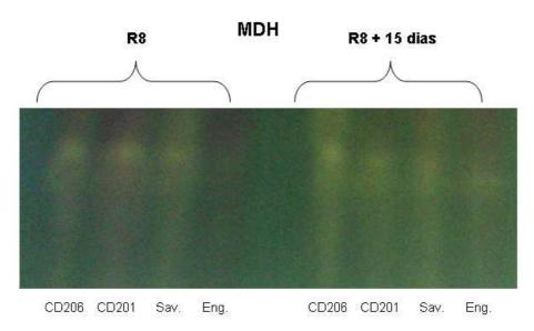
Figura 5 Padrões isoenzimáticos de sementes de soja de alta (CD 201 e CD 206) e baixa qualidade fisiológica (Engopa 316 e Savana), durante as épocas de colheita R8 e R8 + 15 dias, revelados para a enzima MDH
