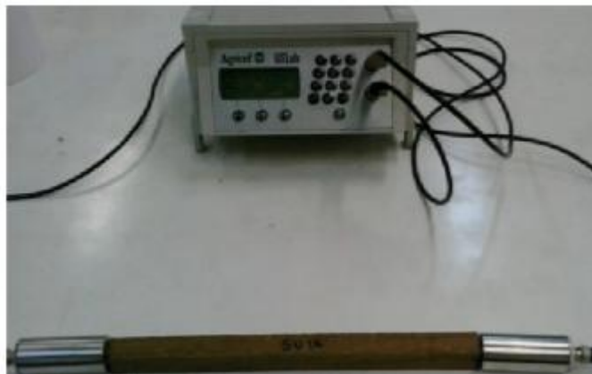
Figura 2 Ensaio com equipamento de Ultrassom.
