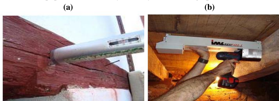
Figura 5 Equipamentos de medição Pilodyn® e Resistograph®.
