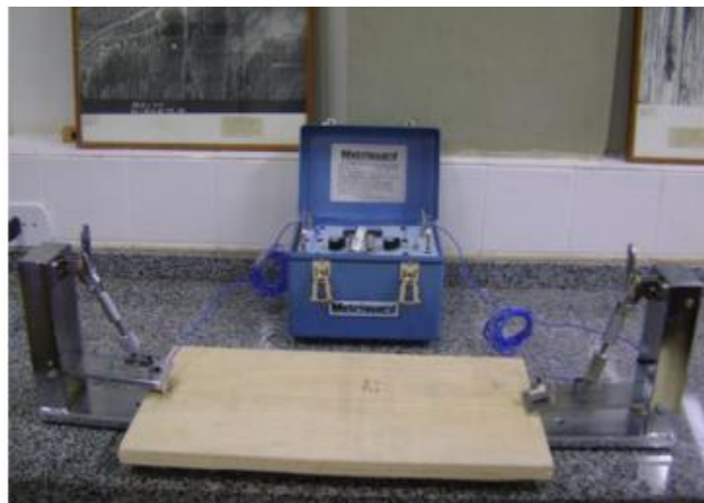
Figura 4 Aplicação do Stress wave timer .
