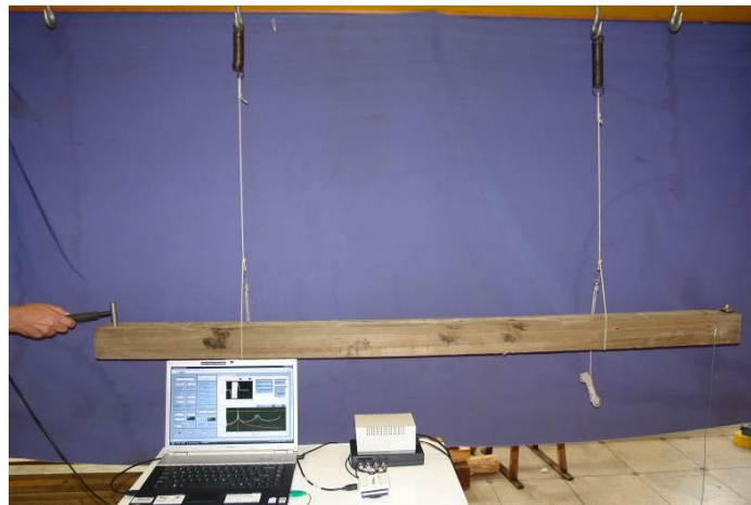
Figura 3 Configuração do ensaio utilizando o método de vibração transversal.
