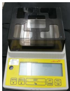
Figura 8 - Balança analítica utilizada para pesagem das amostras.
