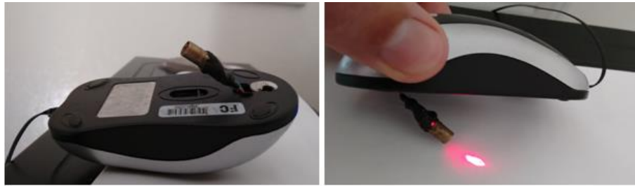
Figura 17 - Modificação na iluminação interna do mouse óptico.
