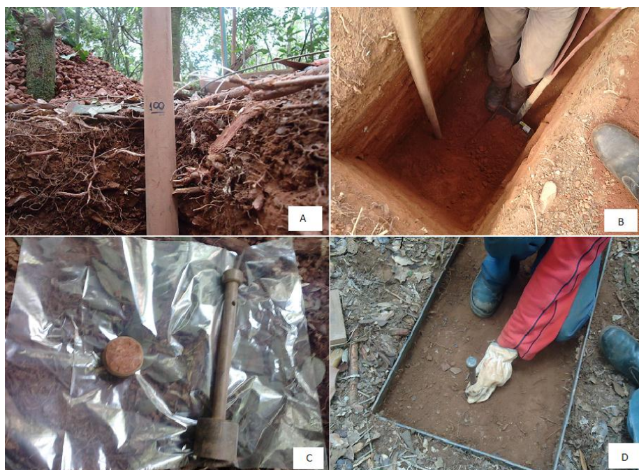
Figura 8. A) Trincheira sendo aberta até 100 cm. B) Detalhe superior da trincheira. C) Anel de volume conhecido utilizado para coletas de amostras indeformadas de solo. D) Anel de volume conhecido sendo utilizado.
