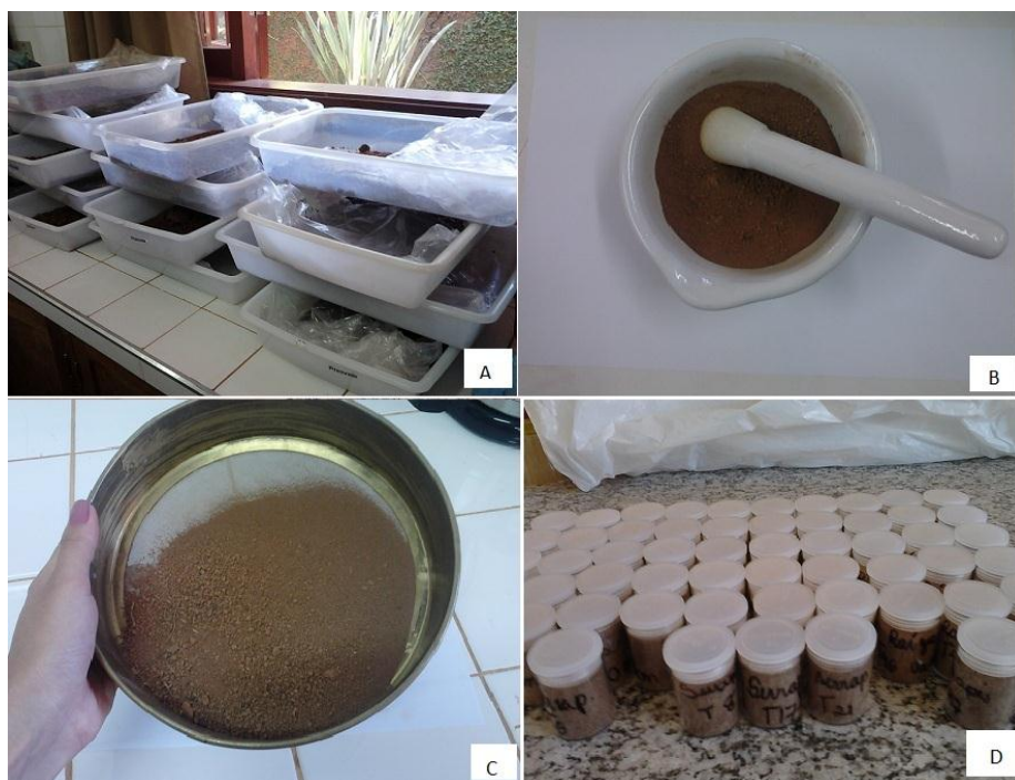
Figura 7. Preparo de solo para análise de carbono. A) Solo coletado sendo seco à temperatura ambiente. B) Solo seco sendo macerado em cadinho de porcelana com pistilo. C) Solo sendo peneirado em peneira de 60 mesh. D) Material armazenado em frascos plásticos.
