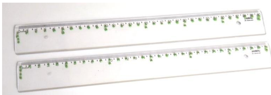
Figura 3 - Régua adaptada para alunos com deficiência visual realizarem medidas das partes inteiras.
