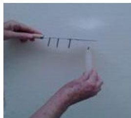
Figura B.3 - Aquecimento da barra metálica com o auxílio de uma vela.
