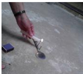
Figura B.1 - Preparação de uma barra metálica para o experimento de condução de calor. Para barra foi utilizada uma escumadeira.
