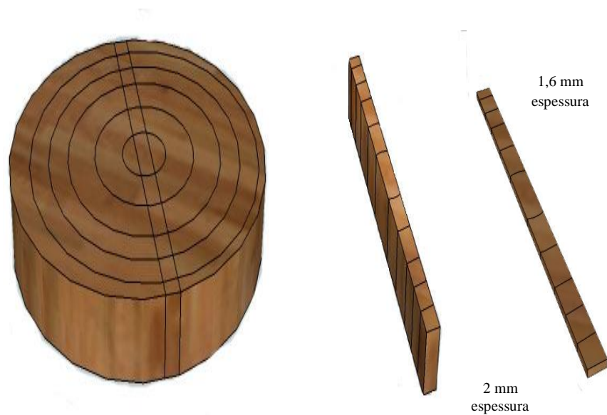
Figura 3 Esquema da retirada das amostras para análise de densitometria de raio X
