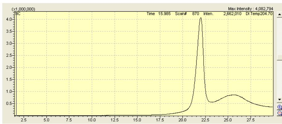
Perfil de aquecimento de azul de metileno sólido (PA), obtido por espectrometria de massas EI.
