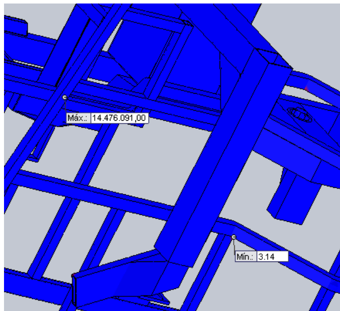
Figura 57 Fatores de segurança máximo e mínimo no estudo cheio inclinado
