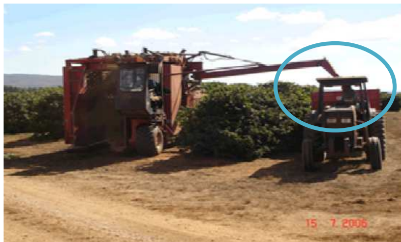
Figura 2 Colhedora de café autopropelida descarregando o café colhido
