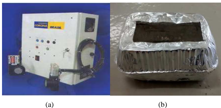
Figura 7 Equipamento de tratamento Corona (a), caixa de alumínio contendo a amostra (b)
