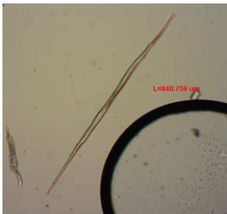
Figura 18 Micrografia do bagaço de cana-de-açúcar com pré-tratamento corona
