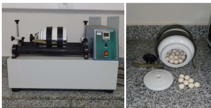
Figura 6 Moinho de bolas com jarros e bolas de cerâmica
