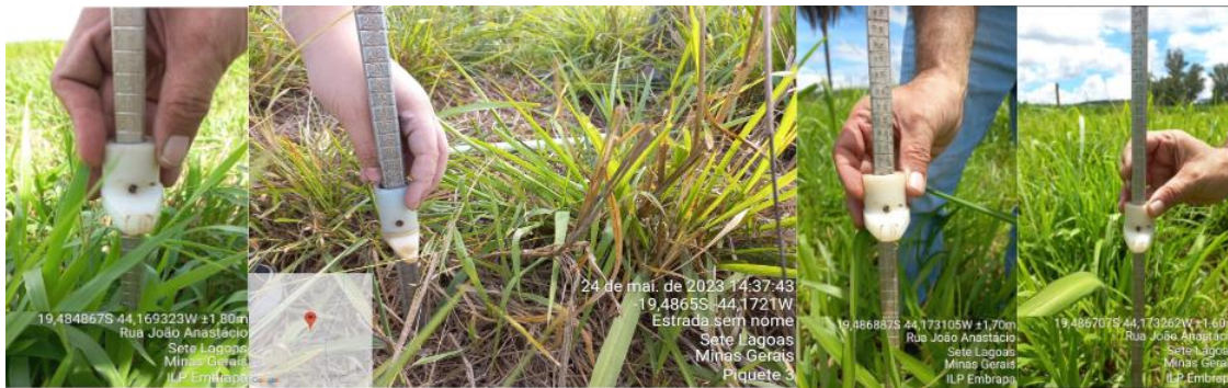
Figura 4: Exemplo de Amostragem georreferenciada com bastão graduado
