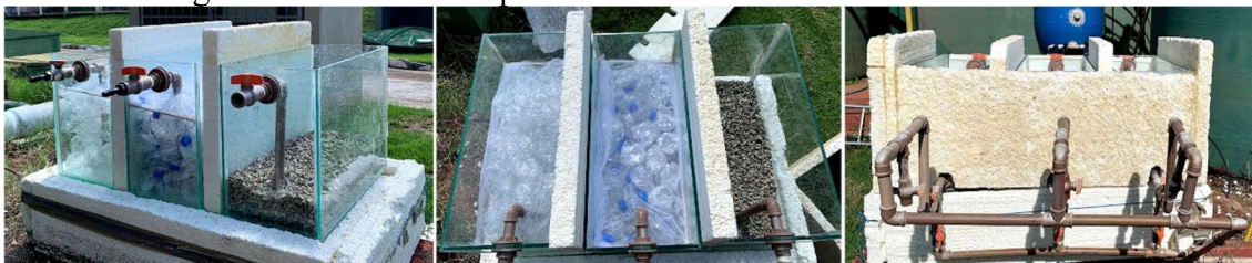
Figura 2 – Placas de isopor inseridos nas laterais dos SACs-EHSS
