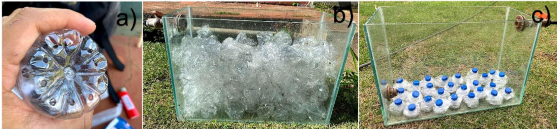
Figura 4 – a) Garrafa PET furada/ b) SAC preenchido com garrafas PET amassada destampada; c) SAC preenchido com garrafas PET amassada tampada
