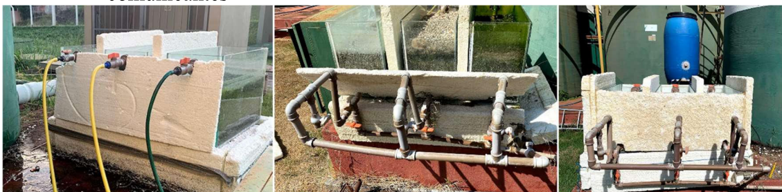
Figura 3 – Tubulações de entrada do efluente e saída fundamentada na teoria dos vasos comunicantes
