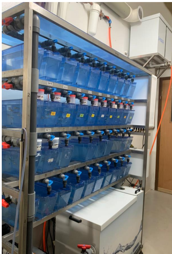
Figura 5. Rack comercial (Hydrus-Alesco) para cultivo de zebrafish ( Danio rerio ) em sistema automatizado de recirculação de água
