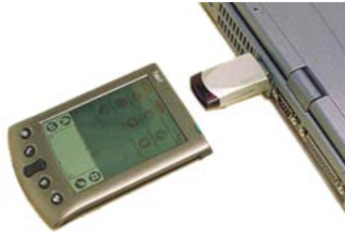
Figura 3.2: Conexão entre Notebook e PDA via infravermelho
