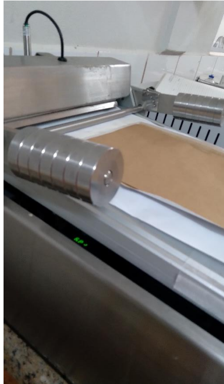
Figura 5 – Pesos removíveis aplicados na máquina de revestimento
