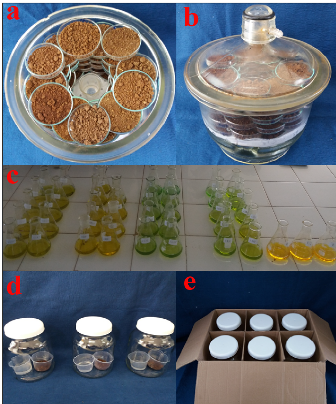
Figura 1 – Ilustração dos procedimentos metodológicos do carbono da biomassa microbiana e respiração basal microbiana. a) incubação do solo com clorofórmio, b) dessecador com amostras de solo fumigadas, c) amostras quantificadas do carbono da biomassa microbiana, d) solo incubado com NaOH e e) armazenado em ausência de luz.
